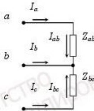
$a, b, c$  – фазы основной вторичной обмотки ТН;  $I_a, I_b, I_c$  – фазные токи;  $I_{ab}, I_{bc}$  – междуфазные токи;  $Z_{ab}, Z_{bc}$  – междуфазные нагрузки
