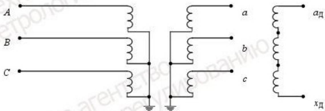
$A, B, C$  – фазы первичной обмотки ТН;  $a, b, c$  – фазы основной вторичной обмотки ТН;  $a_d, x_d$  – фазы дополнительной вторичной обмотки ТН
